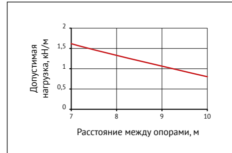
Диаграмма нагрузок на кабельный лоток
